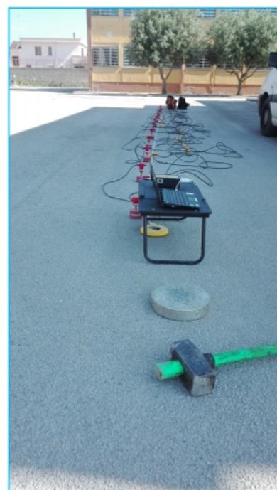
Foto 2- Strumentazione per sismiche M.A.S.W.
