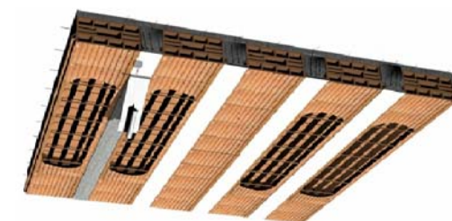
2. Ripristino del materiale cementizio di distacco dei travetti nelle zone degradate, prestando attenzione a passare le armature e a reintegrare l'adeguato coprilegna, in caso di applicazione sotto intradosso dove essere ripristinato, dopo aver colmato eventuali distacchi di isolato con isolante di polietilene, ancorare lateralmente di travetti di C.A.;
