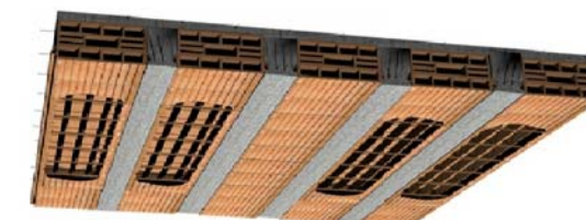
1. Eventuale rimozione delle zone di distacco, se presenti, ed esecuzione di indagine pacometrica diffusa su tutta la lunghezza dei travetti, al fine di determinare l'esatta posizione delle armature ed il loro interasse;
